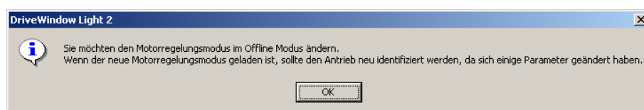
Abb. 10 Den Regelungsmodus des ACS350 oder ACS/ACH550 Frequenzumrichters im Offline-Modus ändern
